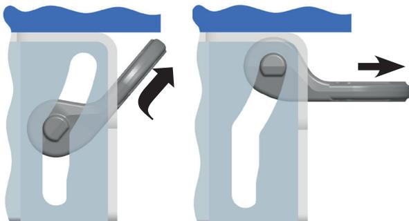
Abb. 16+17: Zurrflasche OPTILASH aus der Kulisse ziehen
