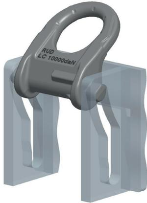
Abb. 3: Erlaubte Montage-Ausrichtung (RUD- und LC-Beschriftung zeigen entgegengesetzt zur Last)
