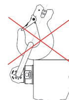
Abb. 5: Verbotene An- bzw. Auflage an Kanten
