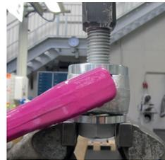
Abb. 10: Auflage des ACP zur Demontage der Schraube
