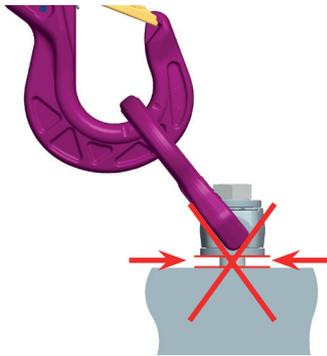
Abb. 5: Der Anschlagpunkt muss vollständig eingeschraubt sein.
