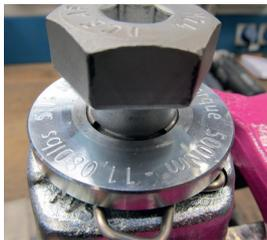
Abb. 12: Sprengring umlaufend vertieft in der Ansenkung positioniert
